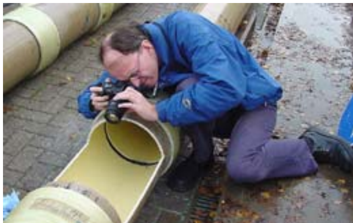
Bild 127: Inaugenscheinnahme der Probekörper nach Abschluss der Prüfung
