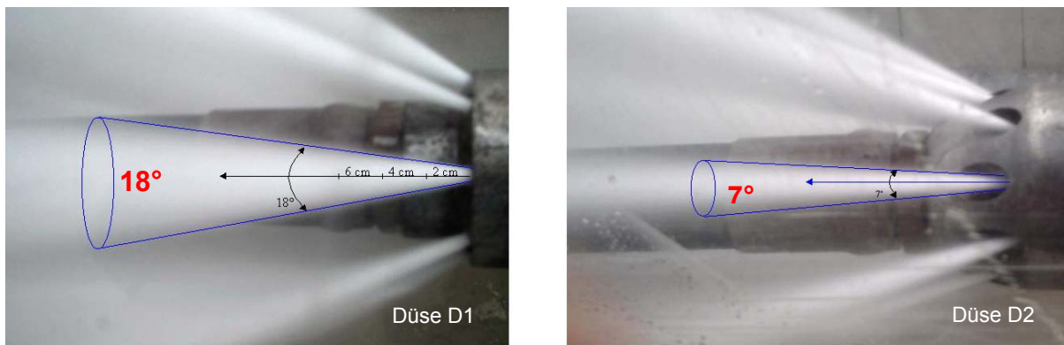
Bild 84: Strahlausbreitungswinkel von zwei Düsen bei gleichem Druck (120 bar) und Gesamt-Durchfluss (320 liter/min)
