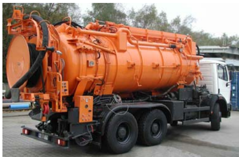
Bild 9: Kombiniertes Spül- und Saugfahrzeug
