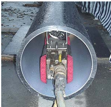
Bild 126: Inspektion mit TV-Kamera
