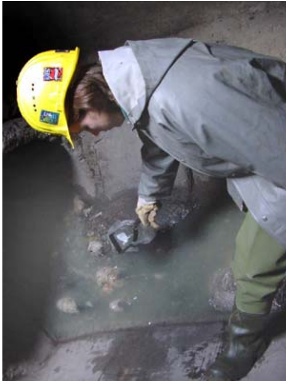
Bild 24: Probenentnahme mit einem Kanalschaber
