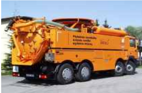
Bild 8: Schlamm- und Feststoffsaugfahrzeug
