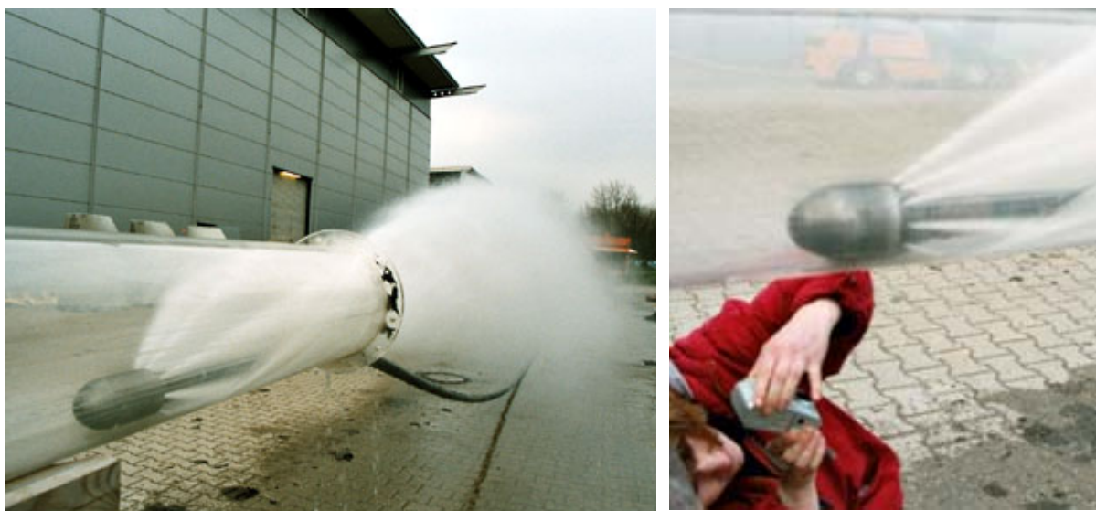
Bild 83: Fotografische Erfassung des Strahlbildes
