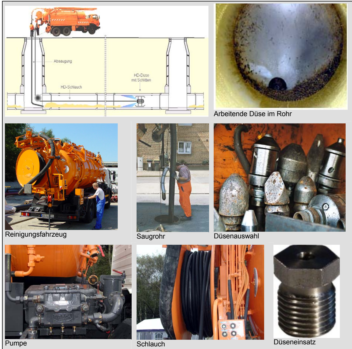
Bild 6: Hochdruckreinigung: Gerätetechnik und Fahrzeug-Komponenten
