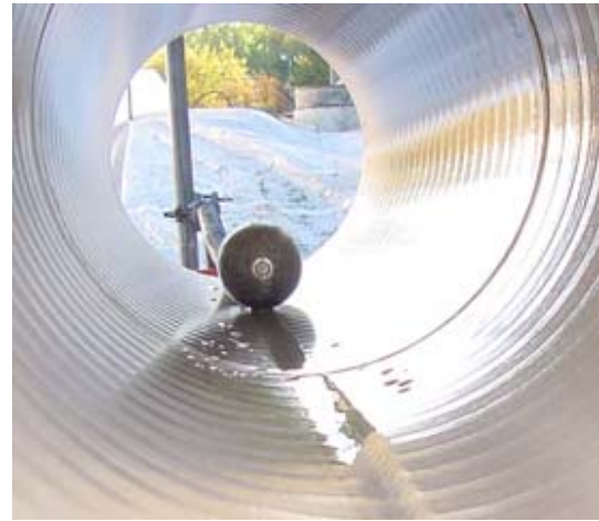
Bild 133: Vorbereitung des Versuchs im Pipe-Tester Bild 134: Prüfdüse D1 im Rohr
