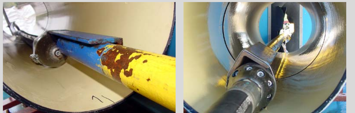
Bild 202: Vorrichtung zur Einstellung eines definierten Strahlabstandes durch Fixierung der Düse an einer freitragenden Stange, das Rohrprüfstück auf dem Schwenktisch ist unterhalb der Düse frei beweglich
