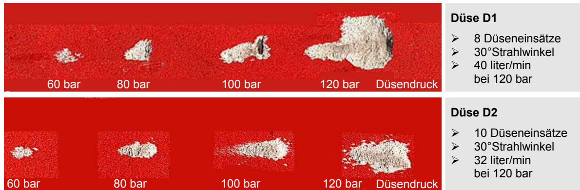
Bild 118: Materialabtrag an oberflächengefärbten Porenbeton-Steinen nach HD-Strahlbelastung, Strahlabstand 18,5 mm, Bildbeispiele
