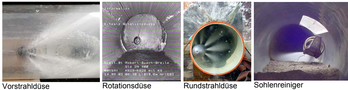
Bild 55: Schwebende Düsen, Bild-Beispiele aus Labor-Versuchen und In-situ-Beobachtungen
