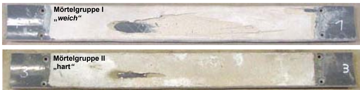
Bild 113: Abrasion an Modellsedimenten aus Mörtel durch stationären HD-Strahl
