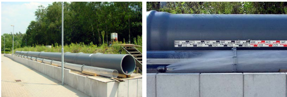
Bild 57: IKT-Prüfstrecken DN 300 (Plexiglas) und DN 800 (PVC)
