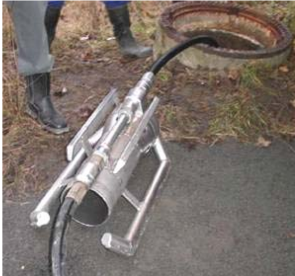
Ejektordüse zur Kanalreinigung Bild 15: Ejektordüsen
