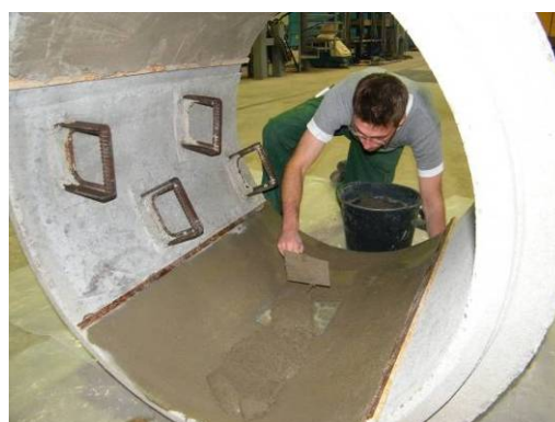
Bild 177 Anfertigung der Probekörper: Mit Trennmittel vorbereiteter Hohlstellenbereich am Probekörper (links) und Auftragen des Beschichtungsmörtels (rechts)
