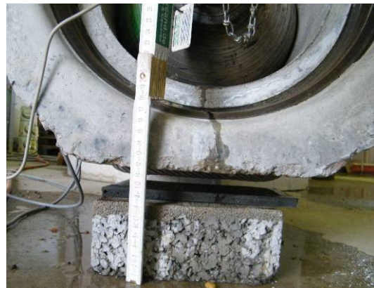
Bild 199 Umsetzung des Prüfprogramms: Vorbereitung einer Dichtheitsprüfung (oben links); Kanalreinigung (oben rechts); Versuchsaufbau für die Abwinkelung (unten links); Abgewinkeltes Betonrohr während des Versuchs (unten rechts)
