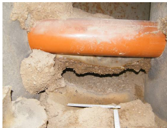
Bild 160 Acrylatgel-Injektionskörper hergestellt bei Grundwasserstufe II an Steinzeug- (links) und PVC-Rohranbindung DN 150 (rechts): Partielle Ablösung des Injektionskörpers von der Rohr- und Schachtwand
