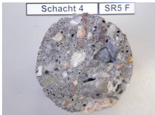
Bild 105: Bruchstelle, exemplarisch für ein vollständiges Versagen im Betonuntergrund
