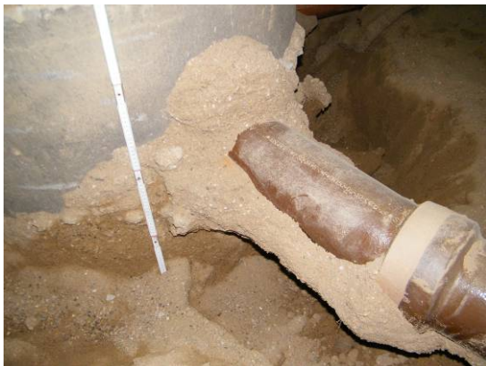
Bild 158 Acrylatgel-Injektionskörper an sanierten Rohranbindungsbereichen der Nennweite DN 150 aus Steinzeug (links) und PVC (rechts)
