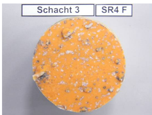
Bild 98 Bruchstelle, exemplarisch für ein vollständiges Versagen in der Verbundfuge zwischen Beschichtung und Betonuntergrund bzw. im Primer
