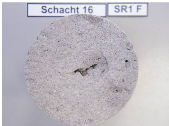
Bild 51 Bruchstelle, exemplarisch für ein vollständiges Versagen in der Verbundfuge
