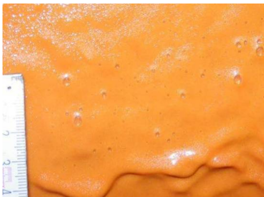
Bild 96 Eprocoat-Beschichtung ohne Grundwassereinwirkung: Bläschen in der Beschichtungsoberfläche (links), Beispiel für einen stärker strukturierten Bereich der Beschichtung und nicht vollständig mit Beschichtungsmaterial umschlossene Steigbügleinbindung (rechts)
