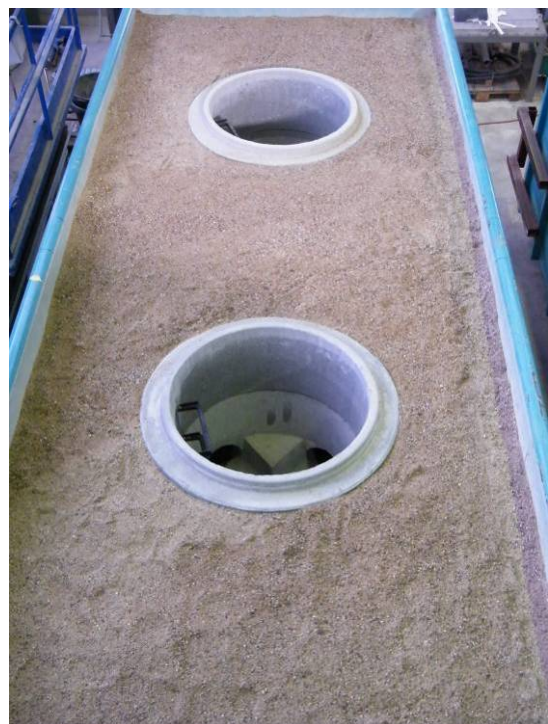
Bild 197 Versuchsaufbau für die einzelnen Sanierungen: Freistehender Rohr-Schachtaufbau (oben links); Blick in ein Schachtunterteil (oben rechts); Einbauzustand ohne Boden (unten links); Fertiggestellter Versuchsaufbau (unten rechts)
