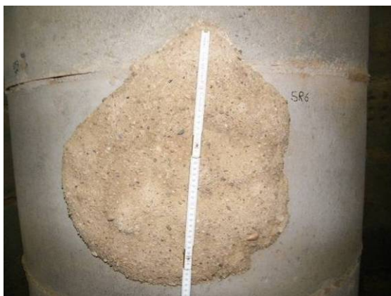
Bild 133 Polyurethan-Injektionskörper einer abgedichteten Fehlstelle FU 6 (links) und LS 7 (rechts)
