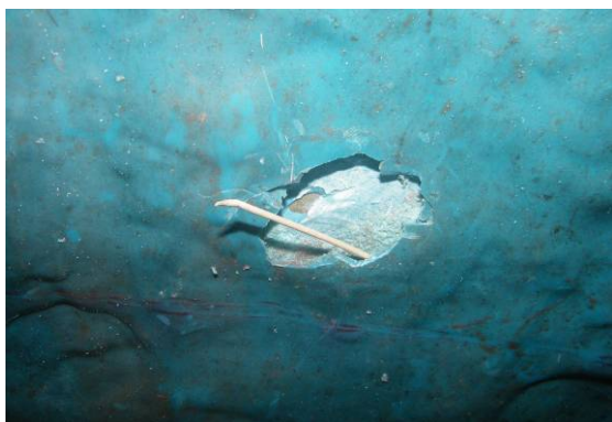
Bild 32 Nicht ausgehärtetes Beschichtungsmaterial (links) und großflächige Ablösung der Beschichtung im Einstiegsbereich (rechts)
