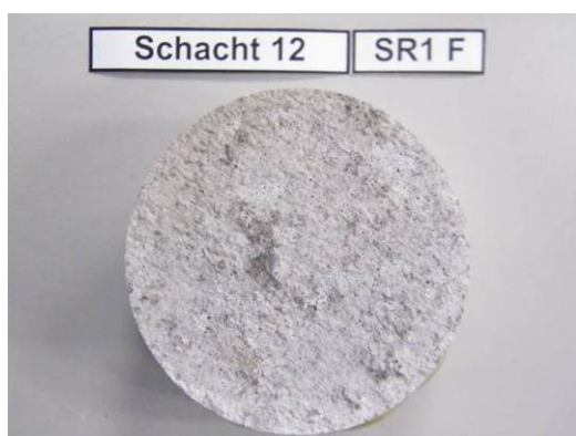
Bild 58 Bruchstelle, exemplarisch für ein vollständiges Versagen in der Verbundfuge
