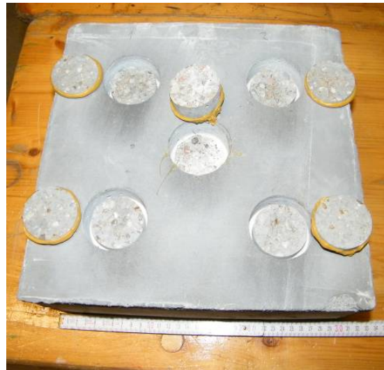
Bild 173 Probekörper für die Haftzugprüfung: Lage der Prüfstellen gemäß [51] (links) und Probekörper A1 nach der Prüfung (rechts)
