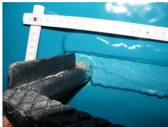
Bild 102 Oldodur-Beschichtung ohne Grundwassereinwirkung: Pinhole in der Beschichtung (links) und geringfügig fehlendes Beschichtungsmaterial im Bereich einer Steigbügelleinbindung (rechts)
