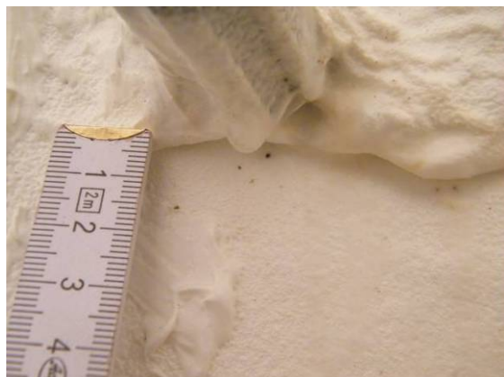
Bild 118 Ultracoat-Beschichtung unter Grundwassereinwirkung: Wassertropfen an einer Steigbügeleinbindung (links) und bräunliche Fließspuren unterhalb dieser zum Ende der Beobachtungszeit (rechts)
