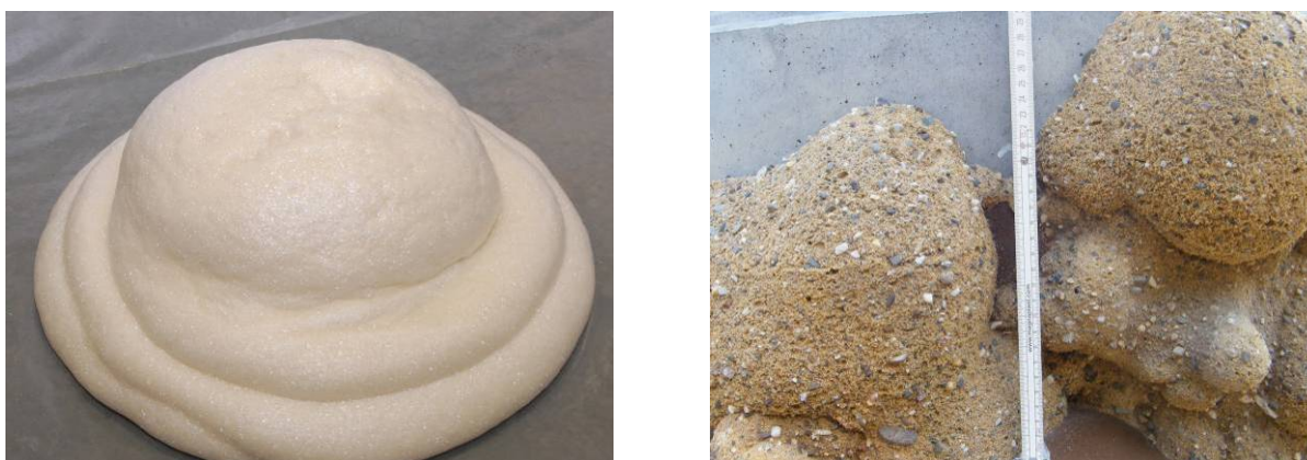
Bild 19 Injektionen auf Polyurethanharzbasis: Ausgehärteter Schaum (links) und Bodeninjektion (rechts)
