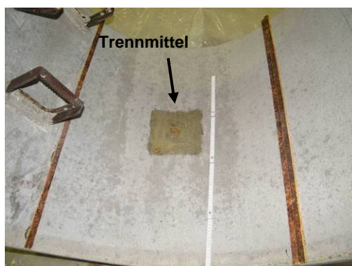
Bild 177 Anfertigung der Probekörper: Mit Trennmittel vorbereiteter Hohlstellenbereich am Probekörper (links) und Auftragen des Beschichtungsmörtels (rechts)
