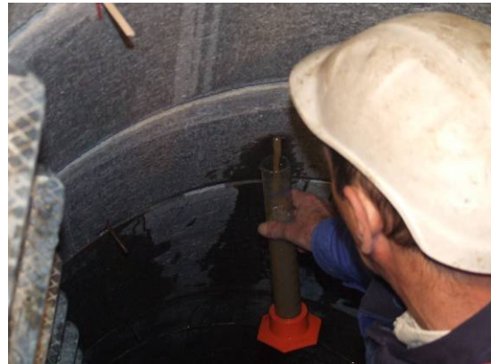
Bild 41 Wassereindrang durch die Schadstellen: Entnahme der Holzdübel (links) und Messung der infiltrierenden Wassermenge (rechts)
