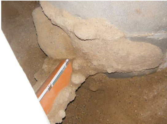
Bild 153 Polyurethan-Injektionskörper, bei Grundwasserstufe I hergestellt, an PVC-Rohr DN 150 (links) und Steinzeugrohr DN 150 (rechts)
