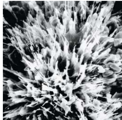
Bild 6 Verkieselte Betonoberfläche, sichtbar durch eingefärbte Silikate [25] (links); Kristalle in Betonporen nach dem Aufbringen eines Kristallbildners [26] (rechts); Beispiele
