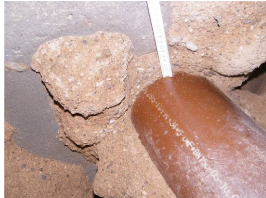
Bild 153 Polyurethan-Injektionskörper, bei Grundwasserstufe I hergestellt, an PVC-Rohr DN 150 (links) und Steinzeugrohr DN 150 (rechts)
