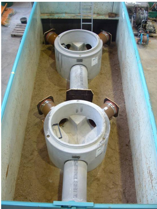
Bild 197 Versuchsaufbau für die einzelnen Sanierungen: Freistehender Rohr-Schachtaufbau (oben links); Blick in ein Schachtunterteil (oben rechts); Einbauzustand ohne Boden (unten links); Fertiggestellter Versuchsaufbau (unten rechts)
