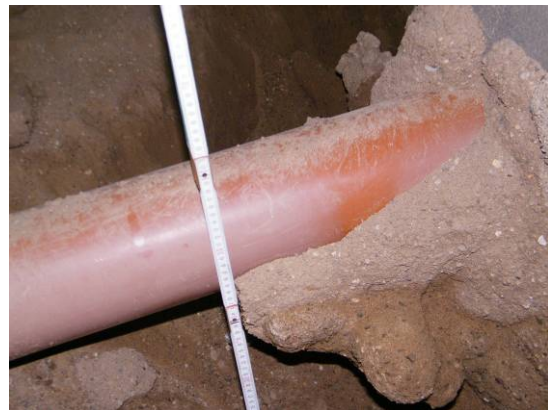
Bild 158 Acrylatgel-Injektionskörper an sanierten Rohranbindungsbereichen der Nennweite DN 150 aus Steinzeug (links) und PVC (rechts)
