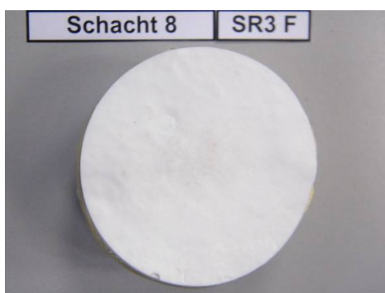
Bild 119 Bruchstellen, exemplarisch für ein vollständiges Versagen in der Beschichtung (links) und im Betonuntergrund (rechts)
