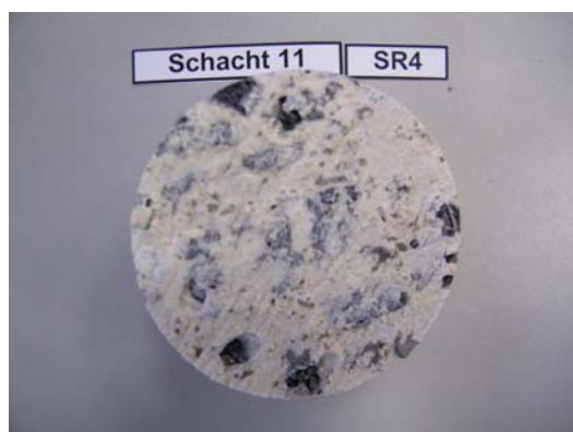
Bild 92 Bruchstellen, exemplarisch für ein vollständiges Versagen in der Verbundfuge zwischen beschichtetem Handlaminat und Betonuntergrund; Probekörper (rechts) zeigt bereichsweise kein Laminat sondern lediglich schwarzes Beschichtungsmaterial
