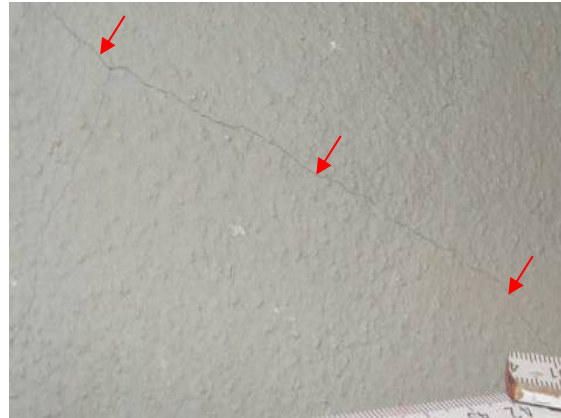
Bild 48 Zustand der Beschichtung ohne Grundwassereinwirkung: Risse erkennbar nach Befeuchten der Beschichtungsfläche mit Wasser (links), Detailbild eines Risses innerhalb einer Hohlstelle (Rissverlauf mit roten Pfeilen angezeigt, rechts)
