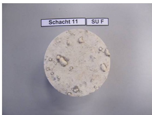
Bild 92 Bruchstellen, exemplarisch für ein vollständiges Versagen in der Verbundfuge zwischen beschichtetem Handlaminat und Betonuntergrund; Probekörper (rechts) zeigt bereichsweise kein Laminat sondern lediglich schwarzes Beschichtungsmaterial
