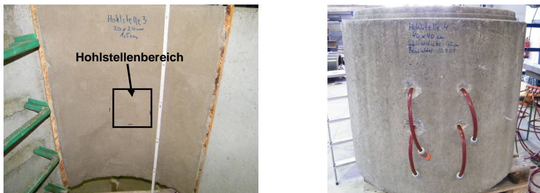
Bild 178 Fertiggestellter Probekörper: Innenseite (links) und Außenseite mit Schlauchanschlüssen zur Wasserdruckbelastung (rechts)
