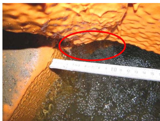
Bild 97 Eprocoat-Beschichtung unter Grundwassereinwirkung (GW I): Abgelöste Beschichtung im Bereich von Hohlstellen aus planmäßiger Verbundschwächung durch Trennmittel FU 2, beidseitig (links) und erheblicher Wassereindrang im Gerinnebereich innerhalb der roten Markierung (rechts)
