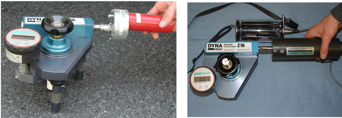
Abb. 47: Haftzugprüfgerät DYN16 der Firma Proceq SA, Zürich mit Elektroantrieben zur Gewährleistung einer konstanten Lastanstiegsgeschwindigkeit von 100 N/s (links), Elektroantrieb zur Sicherstellung einer konstanten Lastanstiegsgeschwindigkeit, u.a. von 300 N/s (rechts)
