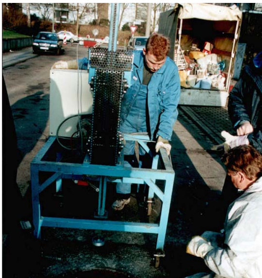
Abb. 34: Polyurethanbeschichtung mittels Sprüh – Schleudertechnik. A: Halterung und Führung der Schleuderscheibe. B: Schleuderscheibe mit Teller, Misch- und Aufsprüh-einheit [62].
