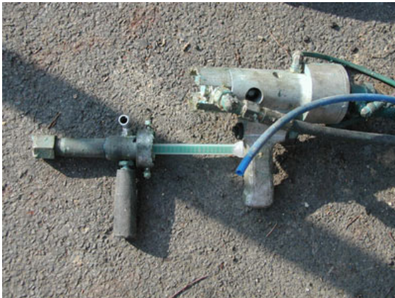
Abb. 31: Mischkopf und Spritzdüse
