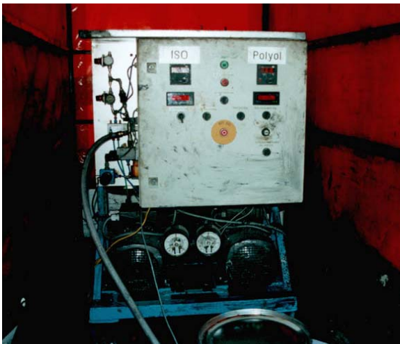
Abb. 30: Auf einen PKW-Anhänger montierte Verarbeitungsmaschine MPS 20 für 2-Komponenten Polyurethansysteme [62]
