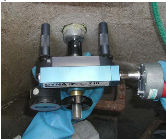
Abb. 45: Durchführung von Abreiß- bzw. Haftzugprüfungen. A: Anbohren einer Betonschachtwand. B: Anbohren einer Beschichtung aus Polyurethan. C: Trocknen der Bohrfläche sowie der unmittelbaren Umgebung. D: Auf eine Beschichtung aus Mörtel geklebter Aluminiumstempel. E: Durchführung einer Abreißprüfung an einer Schachtwand aus Beton. F: Durchführung einer Haftzugprüfung an einer Beschichtung aus Polyurethan.
