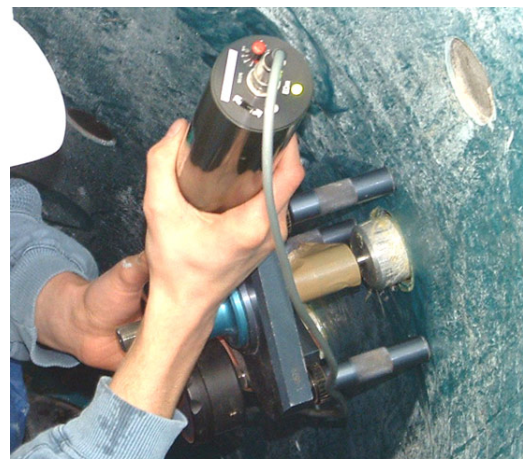
Abb. 45: Durchführung von Abreiß- bzw. Haftzugprüfungen. A: Anbohren einer Betonschachtwand. B: Anbohren einer Beschichtung aus Polyurethan. C: Trocknen der Bohrfläche sowie der unmittelbaren Umgebung. D: Auf eine Beschichtung aus Mörtel geklebter Aluminiumstempel. E: Durchführung einer Abreißprüfung an einer Schachtwand aus Beton. F: Durchführung einer Haftzugprüfung an einer Beschichtung aus Polyurethan.
