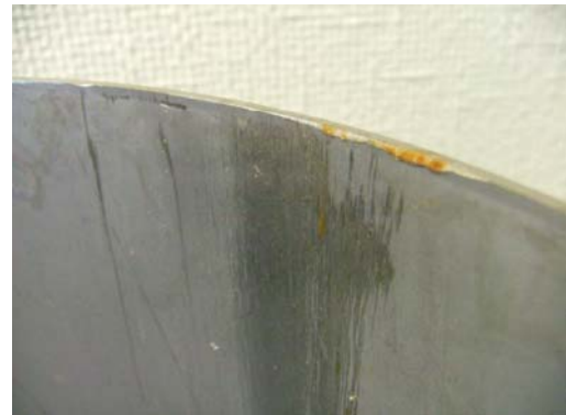
D Geringfügige Kraterbildung auf der Halbschale durch den Aufschlag des spitzkörnigen Gefüges
