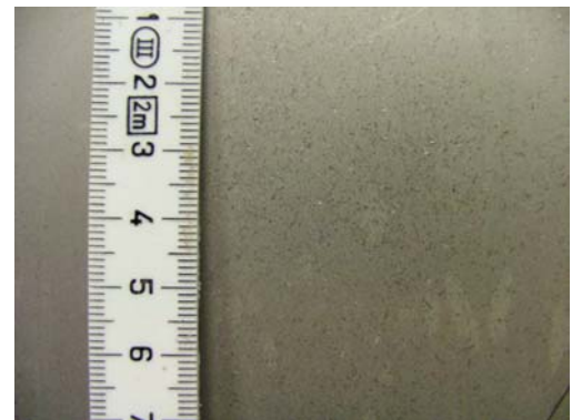
D Geringfügige Kraterbildung auf der Halbschale durch den Aufschlag des spitzkörnigen Gefüges
