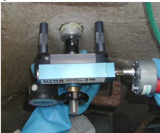
Abb. 3: Durchführung von Abreiß- bzw. Haftzugprüfungen. A: Anbohren einer Beton-schachtwand. B: Anbohren einer Beschichtung aus Polyurethan. C: Trocknen der Bohrfläche sowie der unmittelbaren Umgebung. D: Auf eine Beschichtung aus Mörtel geklebter Aluminiumstempel. E: Durchführung einer Abreißprüfung an einer Schachtwand aus Beton. F: Durchführung einer Haftzugprüfung an einer Be-schichtung aus Polyurethan.
