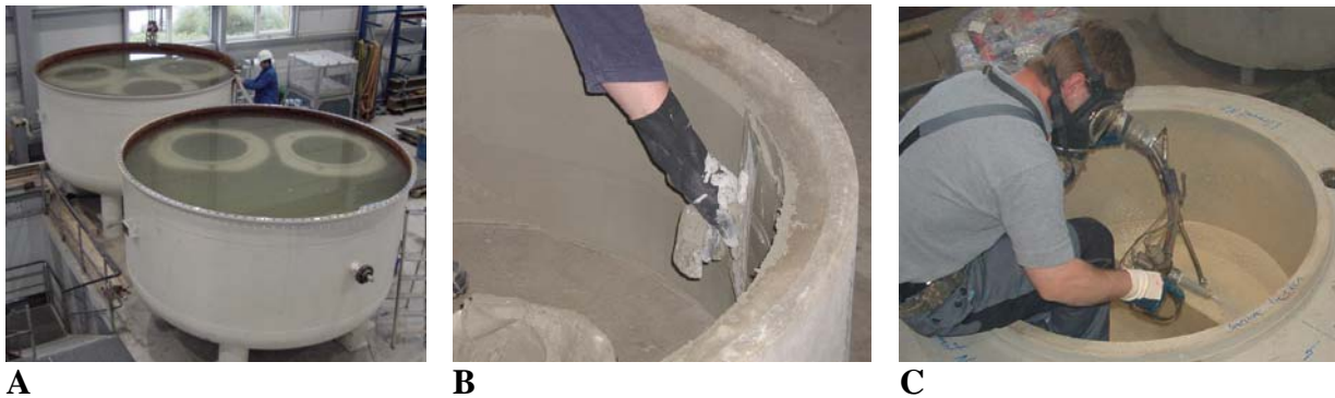
Abb. 19: Wasserlagerung und Beschichtung der Probekörper. A: Vollständige Wasserlagerung der Schachtelemente. B: Mörtelbeschichtung im händischen Auftrag. C: Polyurethanbeschichtung im Aufspritzverfahren.
