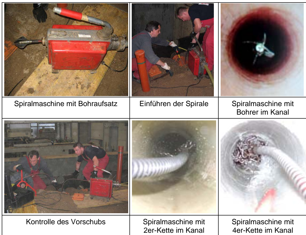
Abb. 17: Einsatz der Spiralmaschine im Großversuchsstand
