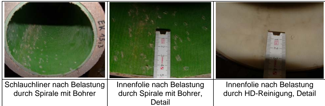
Abb. 18: Beschädigung der Innenfolie, Beispiele
