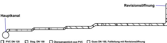
Sanierung von drei Anschlusskanälen aus Steinzeug DN 150 mit einem Dimensions- und Werkstoffübergang auf PVC DN 125; nicht fachgerechter Anschluss zwischen Scheitel und Kämpfer des Hauptrohres mit einem mötelummantelten 67°-Bogen; Inversion durch Revisionsöffnungen in den Falleitungen aus Guss DN 150; vertikale Bögen: 90°, 45° und 30°; horizontale Bögen: 15°; eingebrachte Schäden: Längsrisse, Querrisse, Scherbenbildungen, fehlende Rohrstücke, angedeutete Seitenzuläufe, fehlende Dichtungen.
