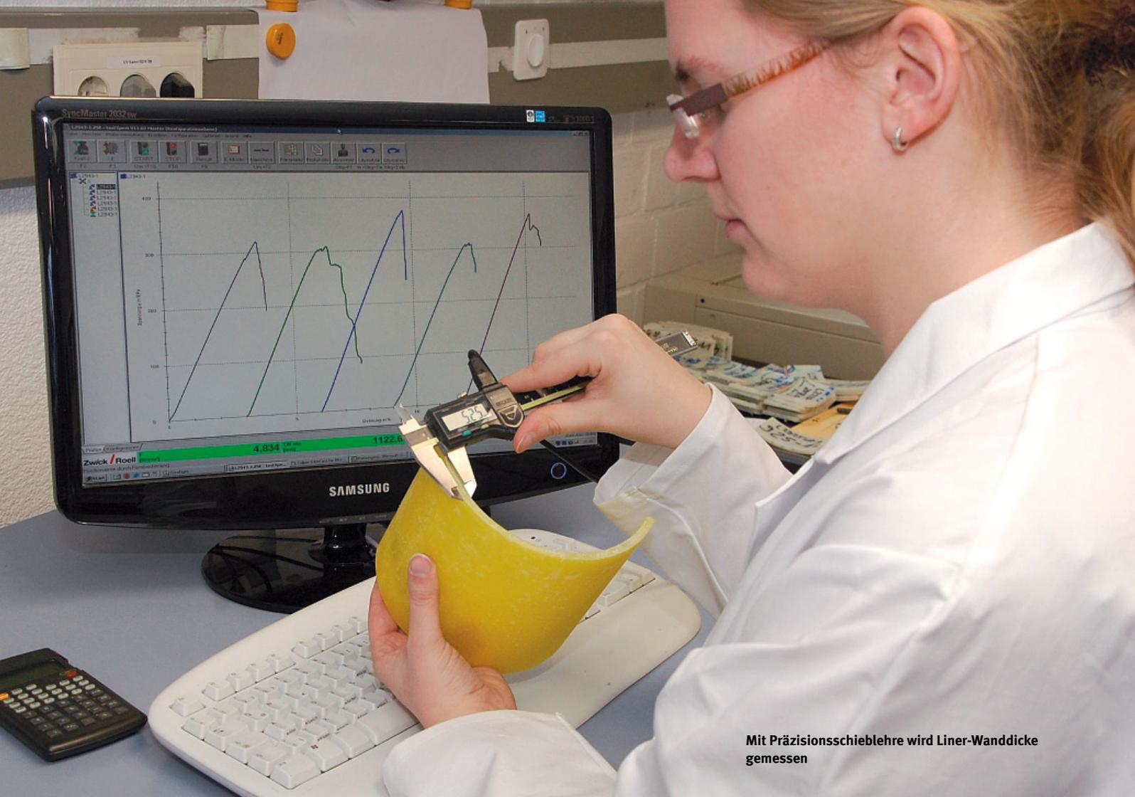
Mit Präzisionsschieblehre wird Liner-Wanddicke gemessen
