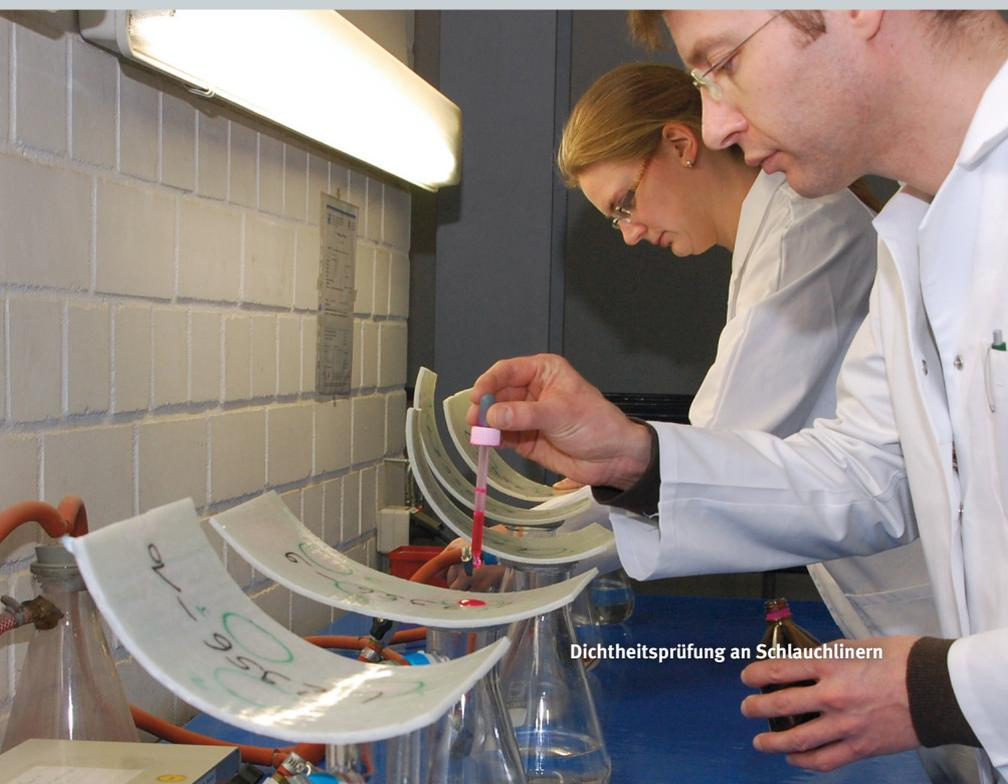
Dichtheitsprüfung an Schlauchlinern
