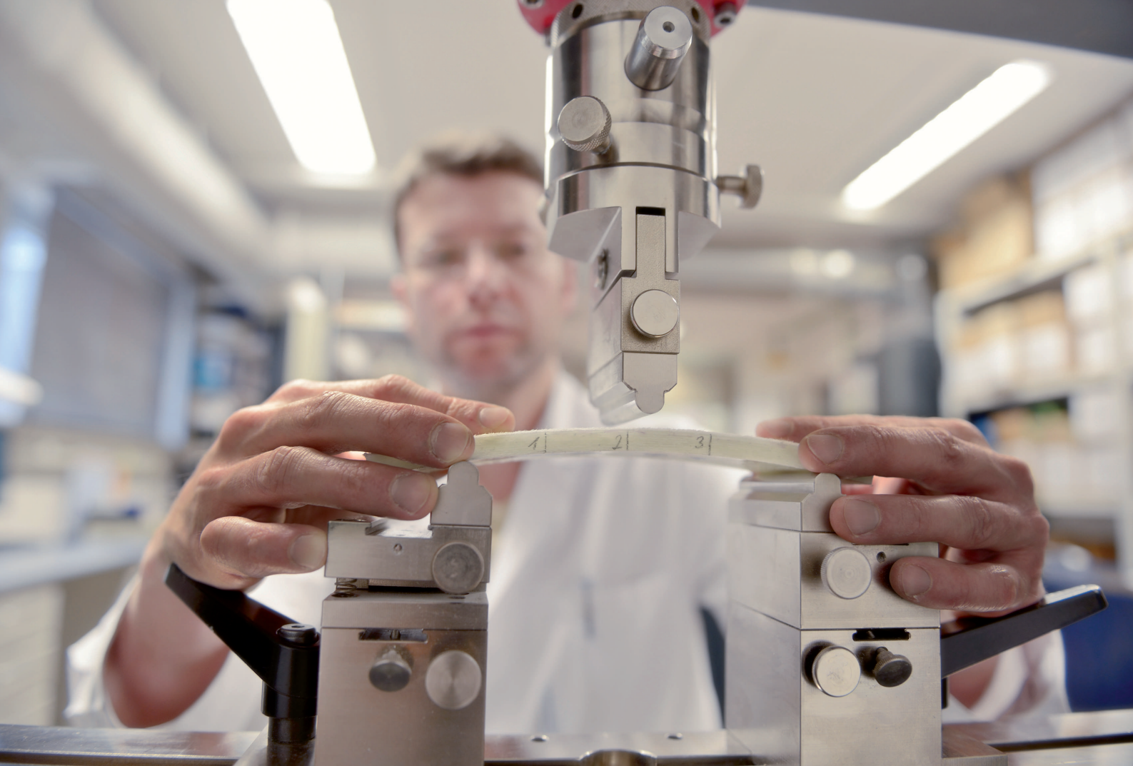
Bild 1: Drei-Punkt-Biegeversuch an Schlauchliner
