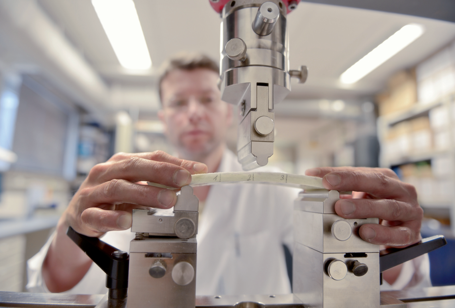
Driepuntsbuigproef op proefstuk
