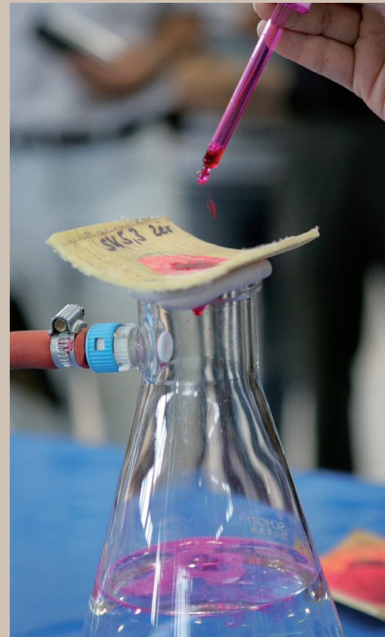
Bild 3: Wasser (rot) tropft durch: Liner undicht!
