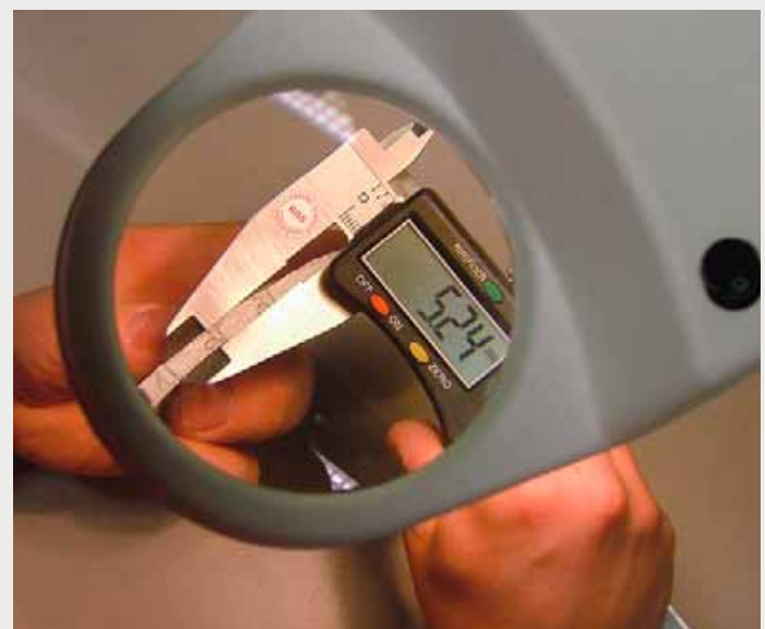
Bild 3: Vermessung der Liner-Wanddicke
