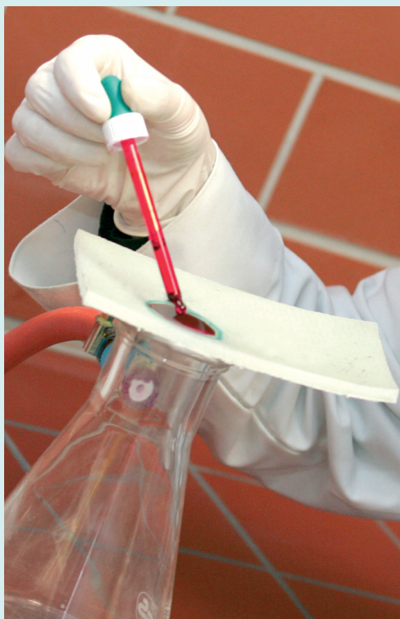
Contrôle de l'étanchéité à l'eau avec une dépression de 0,5 bar
