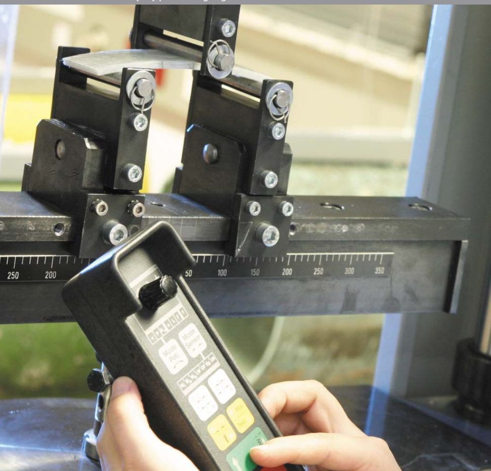
Fot. 4. Test metodą trzy punktowego zginania
