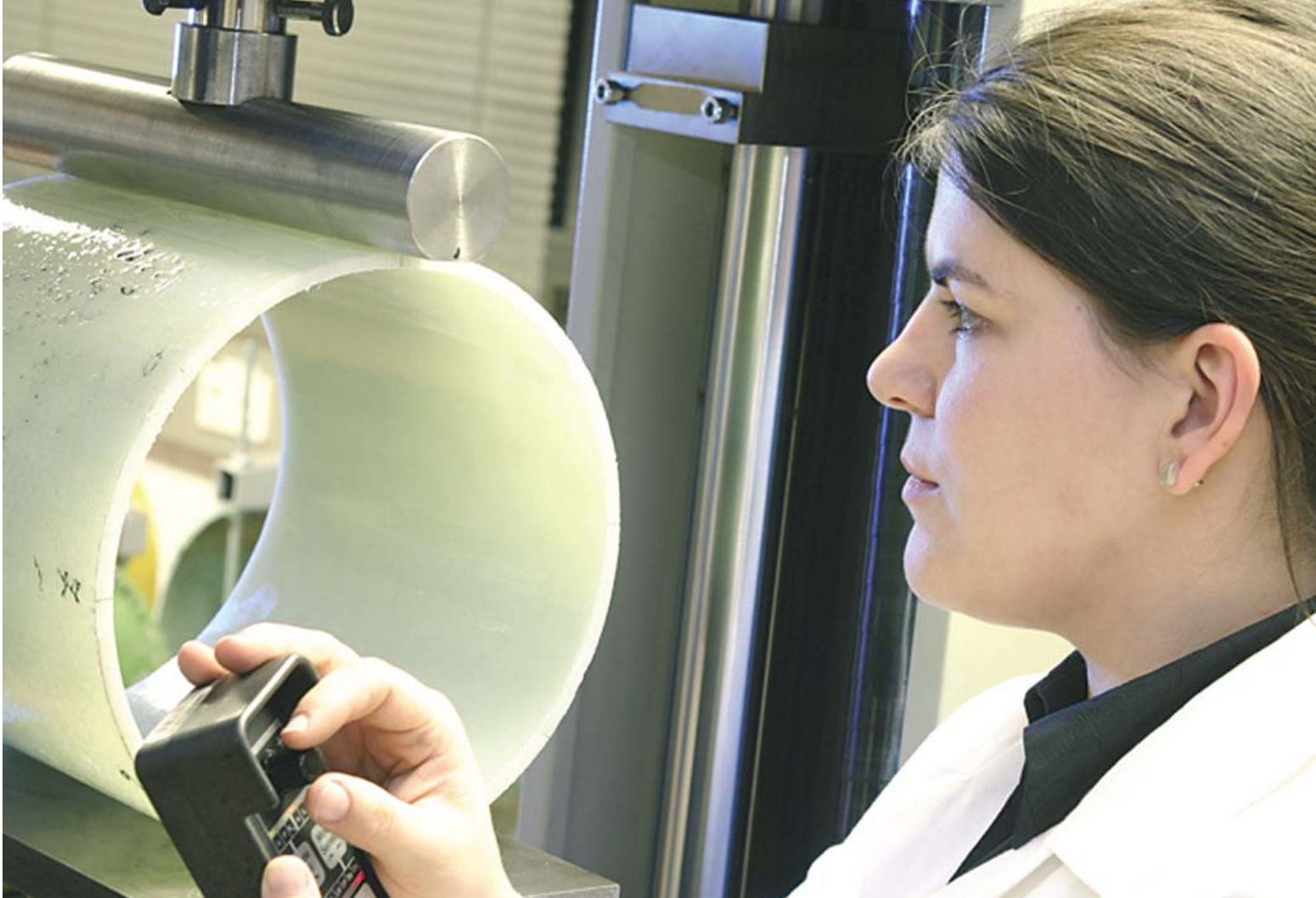
Fot. 3. Test obciążeniowy parallel plate
