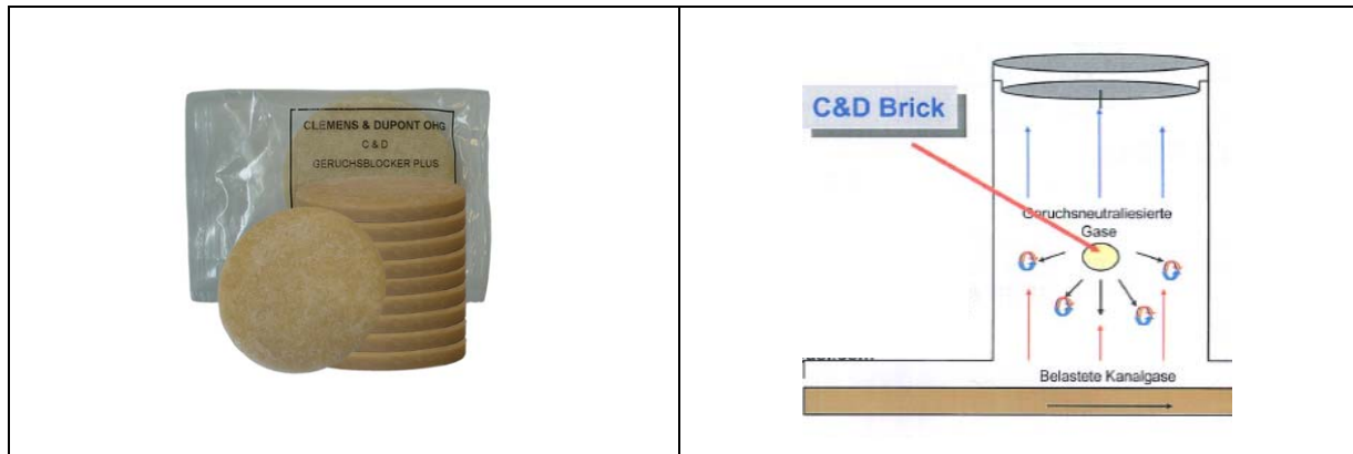
Abb. 15: Ansicht (li) und Skizze (re) des C&D Geruchsblocker [29]
