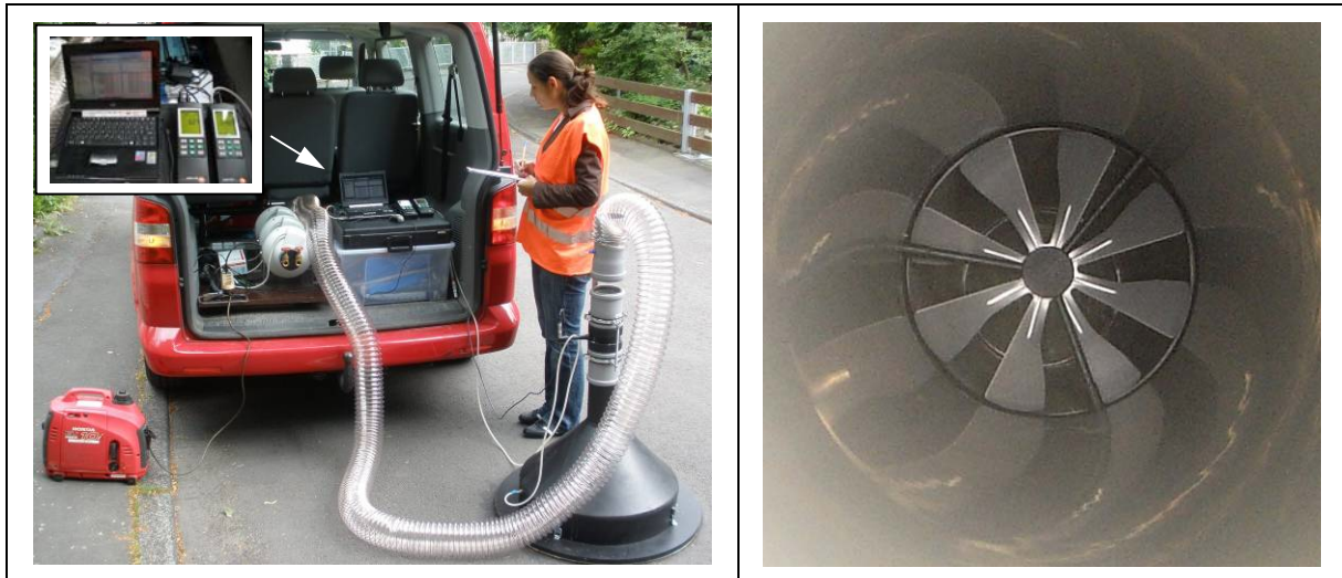
Abb. 30: Versuchsanordnung inkl. Laptop und Messgeräte (li) und eingebautes Flügel-Anemometer (re) [24]
