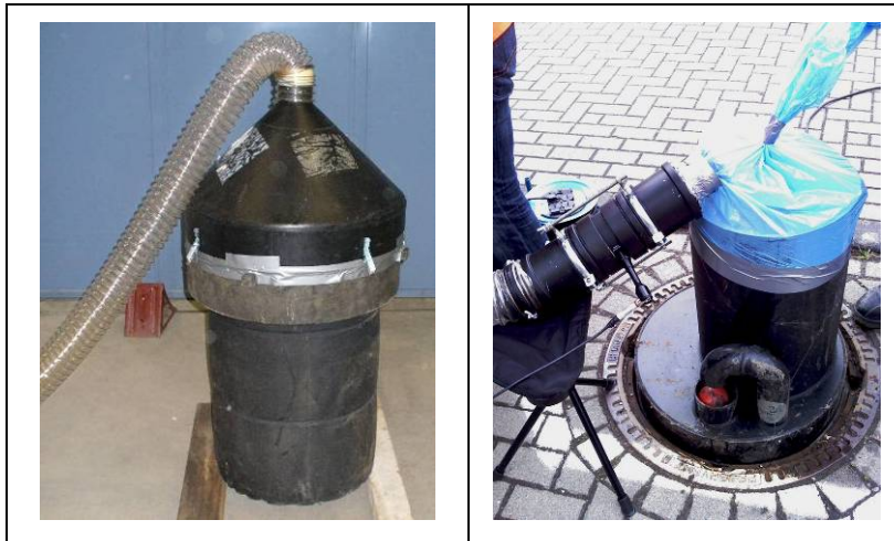
Abb. 31: Messung der Druckkennlinie im Labor (li) und In-situ (re) [24]
