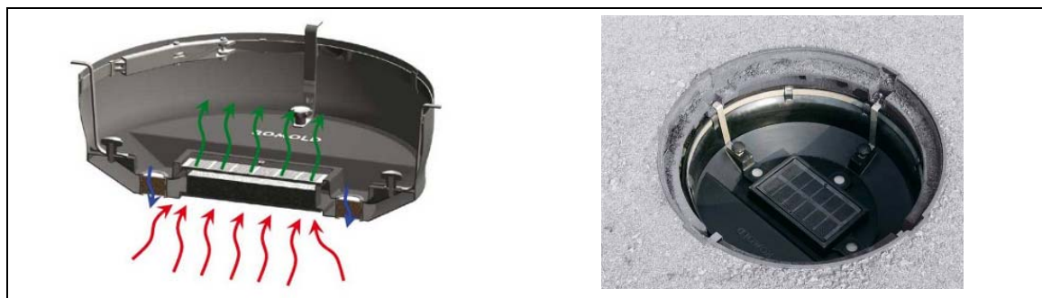
Abb. 6: Prinzip-Darstellung (li) und Praxiseinsatz (re) eines Aktivkohlefilters für Abwasserschächte der ROMOLD GmbH [27]
