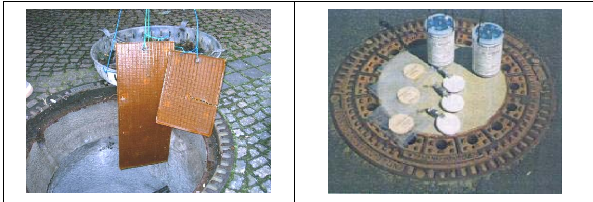
Abb. 7: Plattenförmige Produkte zur Geruchsbekämpfung der Biothys GmbH [28] (li) und Produkte zur Geruchsbekämpfung der Clemens & Dupont OHG [29] (re)
