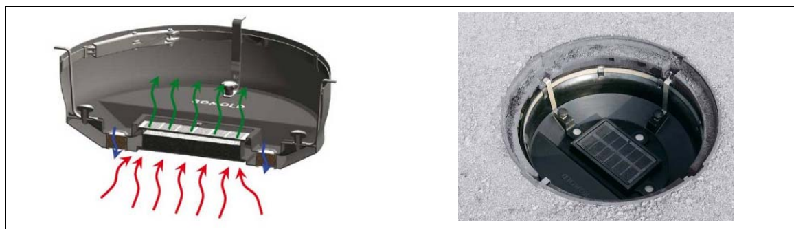
Abb. 3: Prinzip-Darstellung (li) und Praxiseinsatz (re) eines Aktivkohlefilters für Abwasserschächte der ROMOLD GmbH [14]
