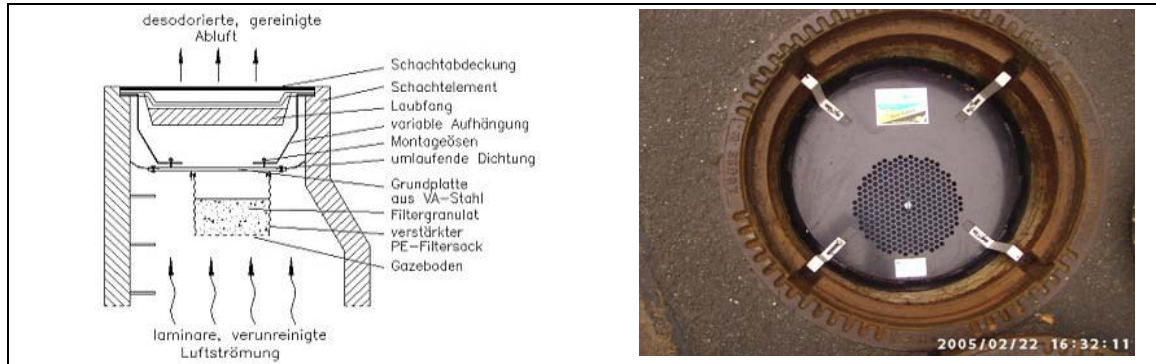
Abb. 2: Prinzip-Darstellung (li) und Praxiseinsatz (re) eines Biofilters für Abwasserschächte der ENTEC Deutschland GmbH [12]
