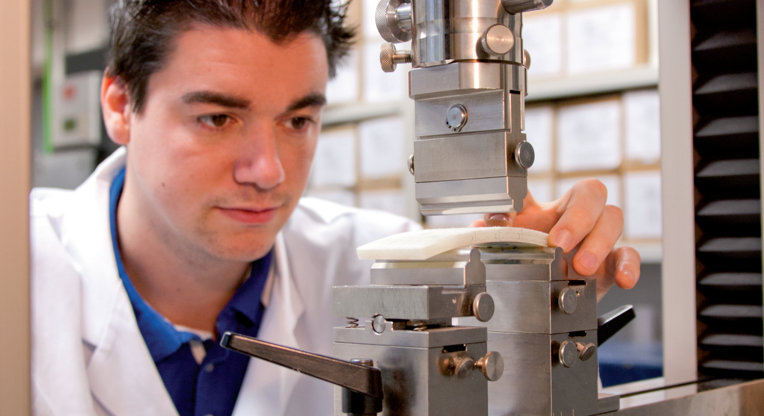
Drei-Punkt-Biegeversuch an Schlauchliner.
