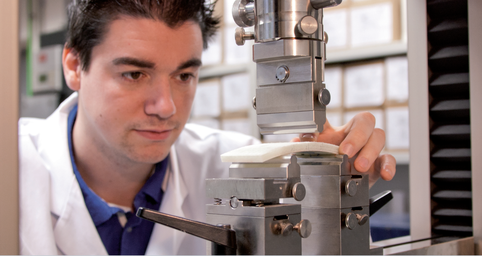
Driepuntsbuigproef op proefstuk
