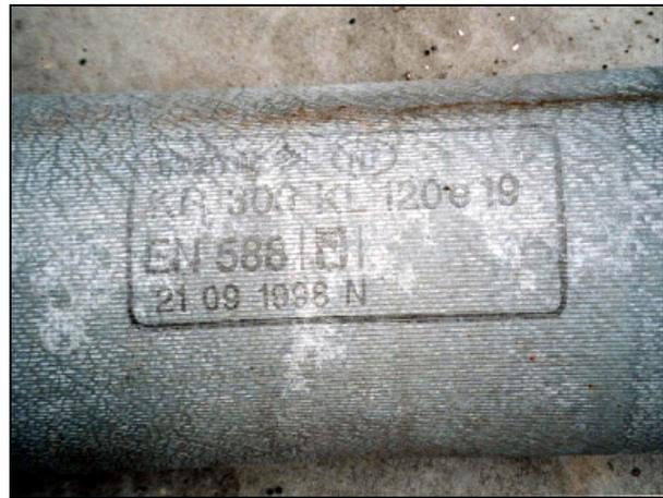
**Abbildung 2: Kennzeichnung eines Faserzementrohres (I)**
