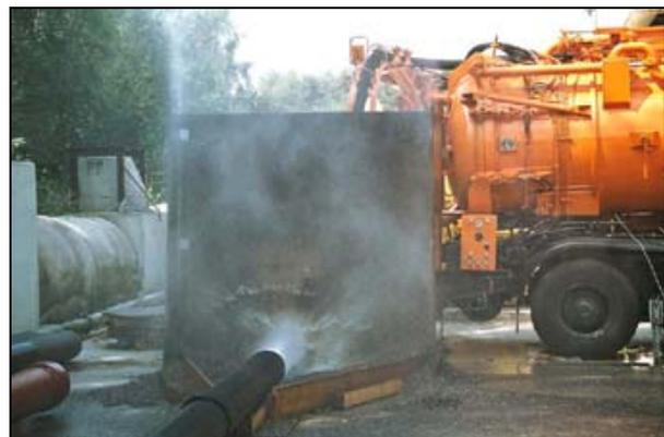
**Abbildung 7: Aerosole bei der Reinigung mit dem HD-Spülverfahren im Versuch (I)**
