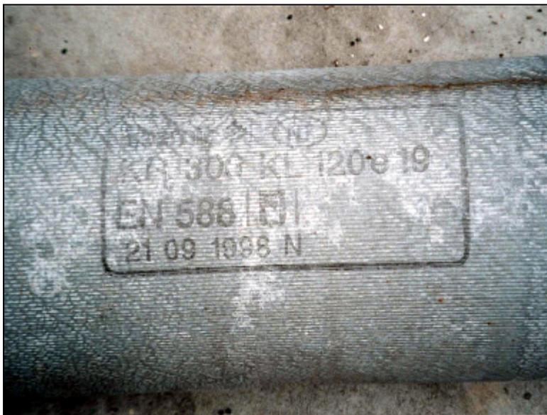
Abbildung 2.7 : Kennzeichnung eines Faserzementrohres nach DIN EN 588 (I)
