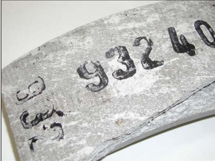
**Abbildung 5.2: Farbe und Oberfläche eines Asbestzementrohrbruchstückes (I)**
