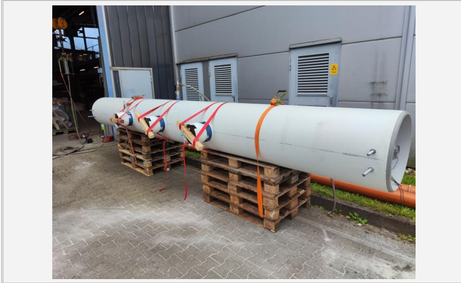
Abb. 4 Prüfaufbau für die Dichtheitsprüfung nach Einbau
