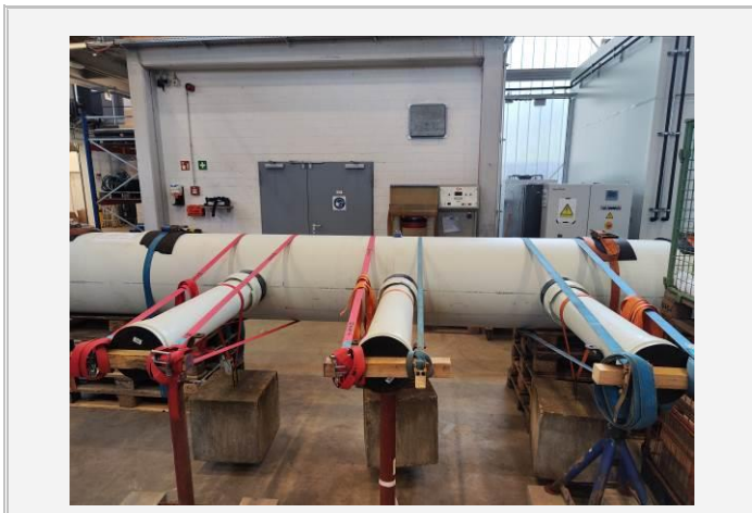
Abb. 6 Versuchsaufbau der Langzeitscherlastprüfung
