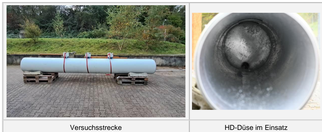
Abb. 7 Versuchsaufbau und Durchführung der Hochdruckreinigung
