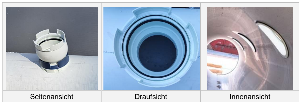
Abb. 3 Beim IKT-Warentest eingebaute POLO-ECO plus Premium Anbohrstutzen
