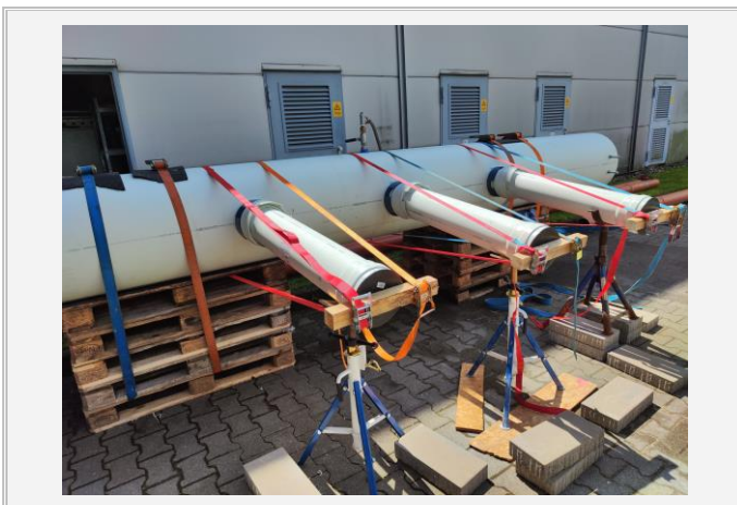
Abb. 5 Versuchsaufbau für die Dichtheitsprüfung unter Abwinklung
